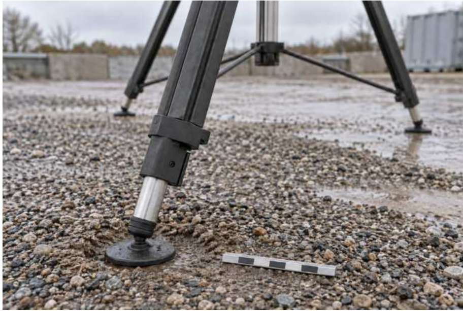
Şekil 1: Nemli ince çakıla bastıran yuvarlak tripod ayağının yakından görünümü; arkadaki iki ayak daha sağlam zeminde duruyor
