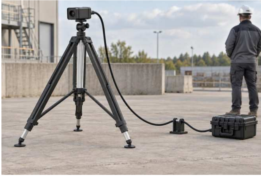
Şekil 3: Tripoda bağlı kamera; geniş bir kablo kavisini, beton üzerindeki alçak ve bağımsız kablo desteğine ve ekipman kutusuna uzanıyor
