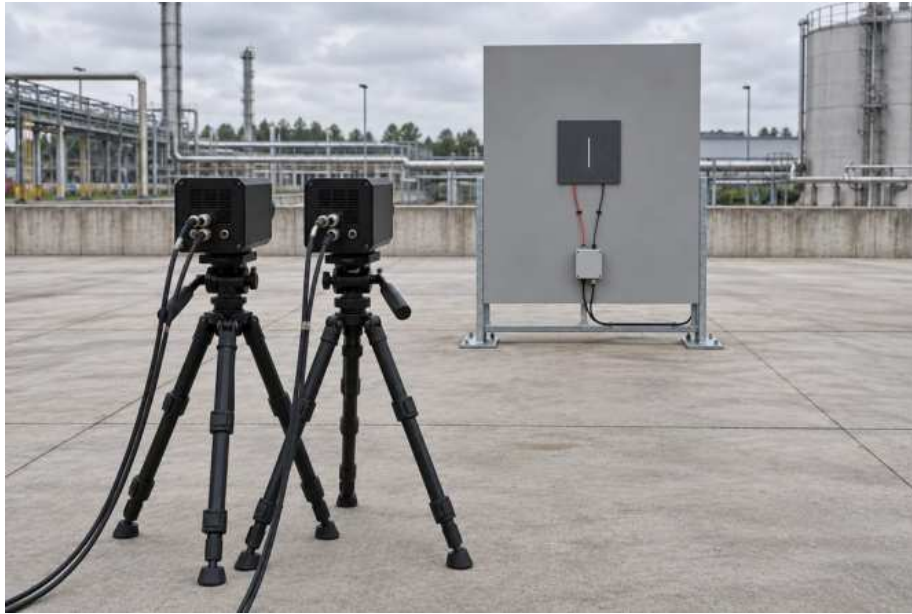
Şekil 3: Yan yana iki tripod üzerindeki kameralar, geniş gri zemin üzerinde dar dikey aralığı bulunan ısıtılmış tek bir test plakasına bakıyor
