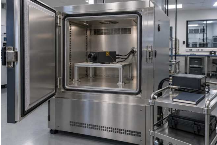
Şekil 3: Gövdeye bağlı probu ve yan porttan geçen kablolarıyla açık sıcaklık koşullandırma kabini içinde kamera test düzeneği
