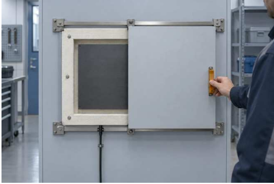
Şekil 1: Bir teknisyen, sıcak test yüzeyinin görünen şeklini değiştirmek için opak maskeyi yana kaydırıyor
