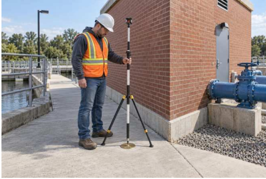
Şekil 2: Harita teknisyeni, sivil pompa binasının köşesindeki pirinç referans işareti üzerinde bir jalonu kontrol ediyor
