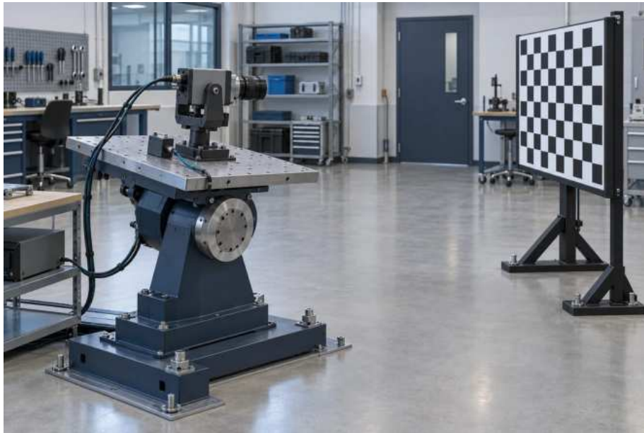
Şekil 3: Eğilen hareket tablasındaki optik kamera, laboratuvar zeminine bağımsız sabitlenmiş dama desenli hedefe bakıyor
