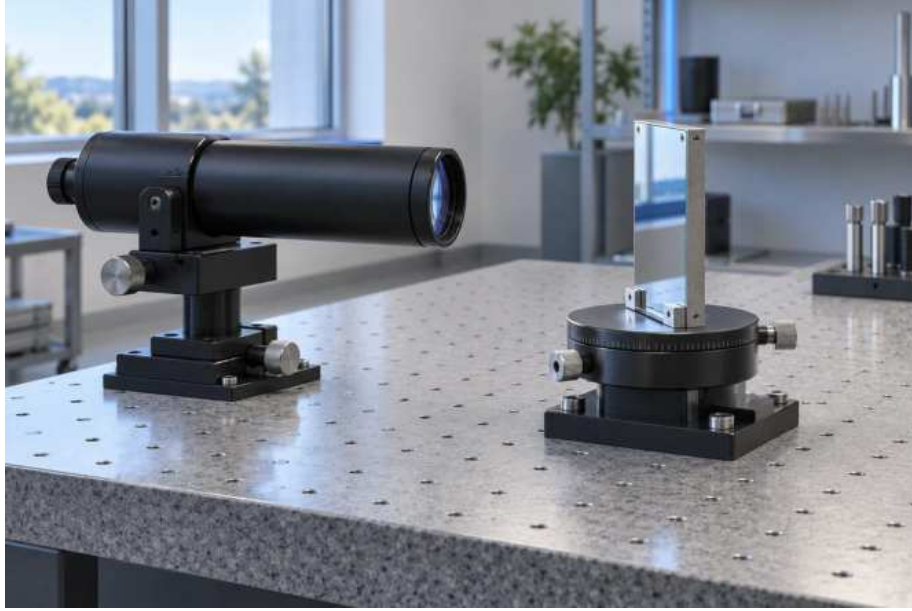
Şekil 1: Bağımsız optik açı cihazı, laboratuvar tablasındaki döner platforma bağlı düz aynaya bakıyor
