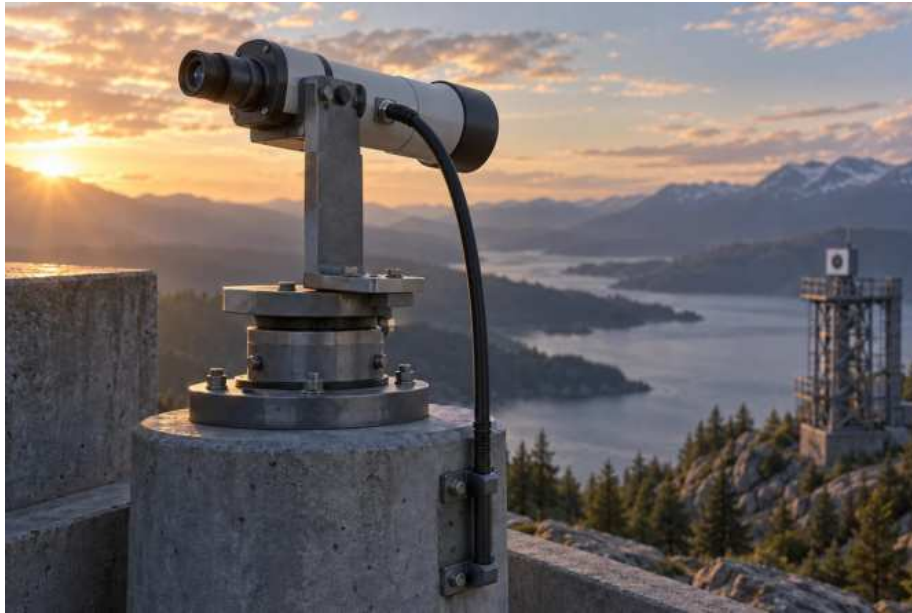
Şekil 3: Saha teleskobu metal braket ve döner yatak üzerinde; servis kablosu alçak güneş ışığında sabit kaideye tutturulmuş
