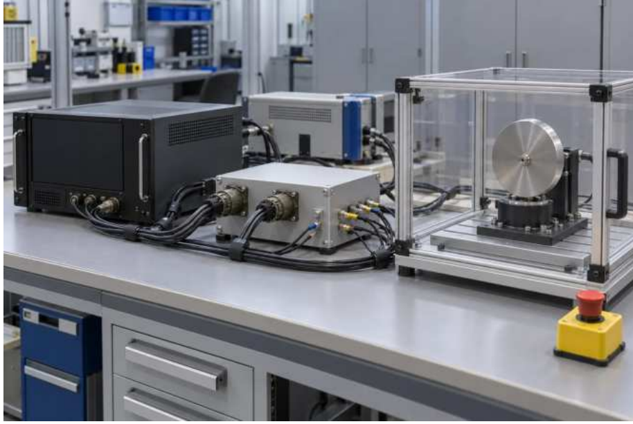
Şekil 3: Laboratuvar kontrol birimi, problemlenmiş arayüz bağlantı paneli üzerinden eylemsiz metal disk taşıyan korumalı döner test düzeneğine bağlanıyor
