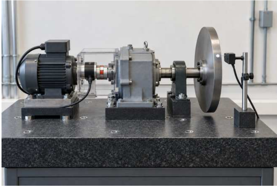
Şekil 3: Döner bir test düzeneğinde motor tarafı sensörü ve dişli kutusunun ötesindeki çıkış diskinde bulunan işareti izleyen ayrı bir optik sensör var
