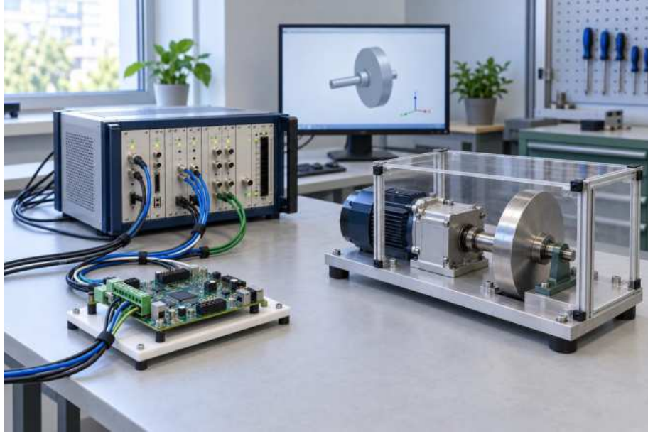
Şekil 1: Bir denetleyici kartı simülátöre bağı; yanında korumalı ayrı bir döner mekanizma ve mekanik şeklini gösteren bir monitör bulunuyor
