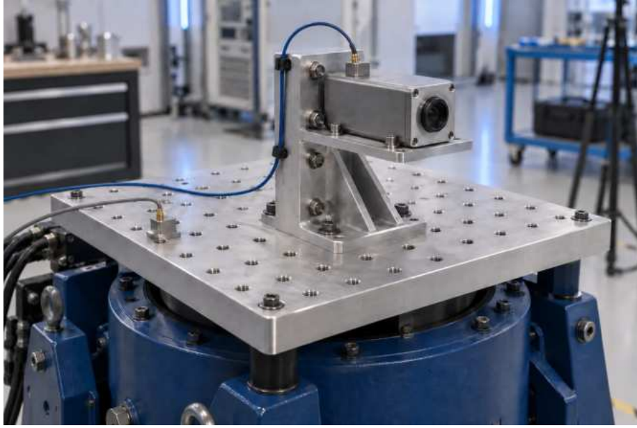
Şekil 3: Güçlendirilmiş braket üzerindeki optik modül sarsıcı tablanın üstünde; tablaya ve modüle ayrı sensörler yerleştirilmiş
