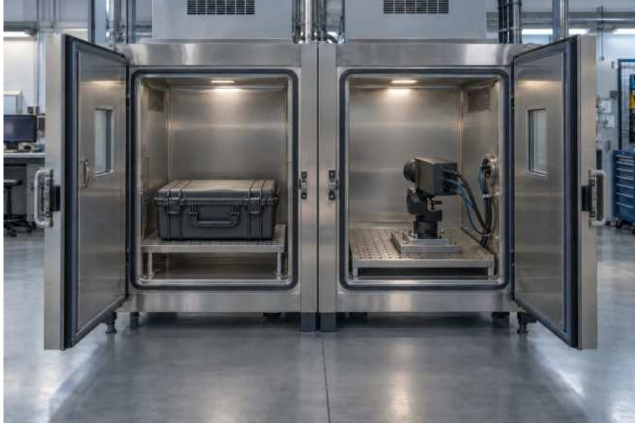
Şekil 1: İki açık çevresel test kabini; solda kapalı taşıma çantası, sağda bağlantıları yapılmış kamera montajı bulunuyor
