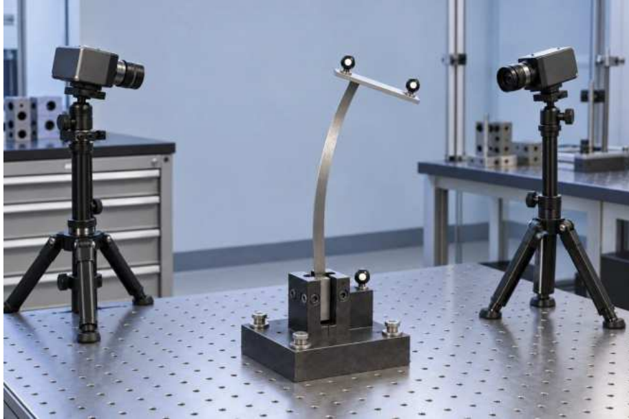
Şekil 3: Eğri bir metal şerit üzerinde iki optik hedef taşıyan rijit bir tepe plakası iki laboratuvar kamerasıyla izleniyor; üçüncü hedef sabit tabanı işaretliyor
