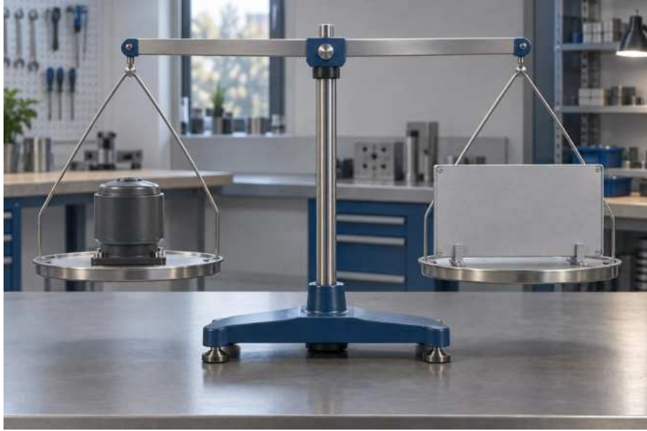
Şekil 1: Dengede duran bir terazinin bir kefesinde kompakt muhafaza, diğerinde geniş ve dik bir panel bulunuyor; kütleler eşit, rüzgâra açık şekiller farklı
