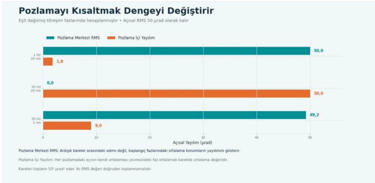
Şekil 3: Eşleştirilmiş çubuklar; 20 milisaniyede 1 Hz, 20 milisaniyede 50 Hz ve 2 milisaniyede 50 Hz için faz ortalamalı pozlama konumu ile pozlama içi yayılımı karşılaştırıyor
