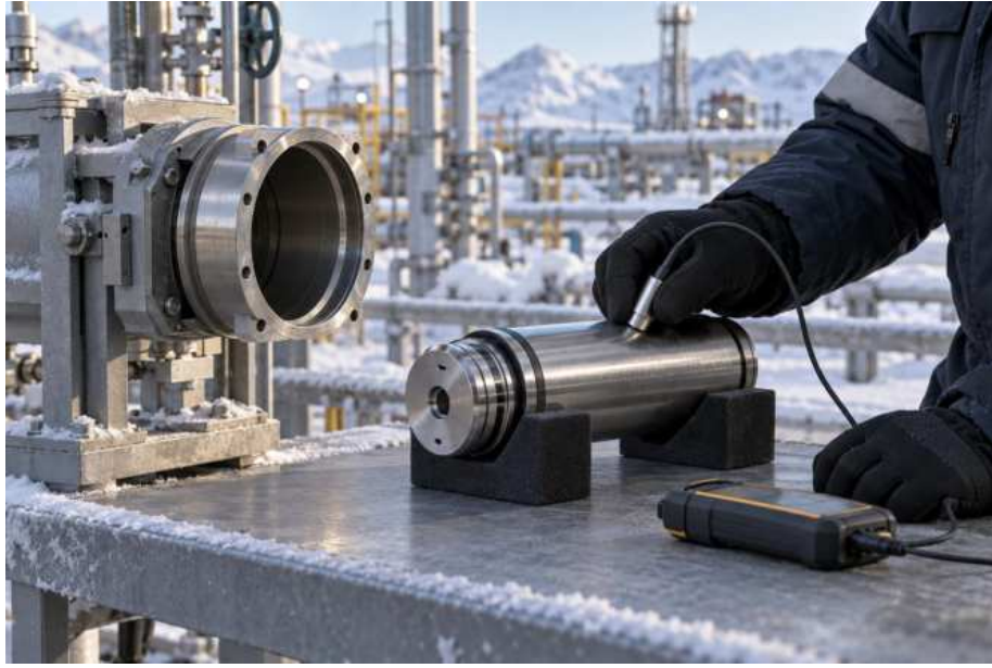
Şekil 3: Eldivenli teknisyen kışın açık hava ekipman kovani yanında kartuş yüzeyini temaslı sıcaklık probuyla kontrol ediyor
