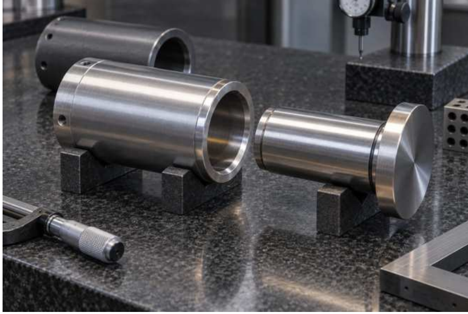
Şekil 1: Hassas silindirik kartuş, kontrol destekleri üzerindeki eşleşen kovanın yanında; arkada ikinci bir kovan bulunuyor
