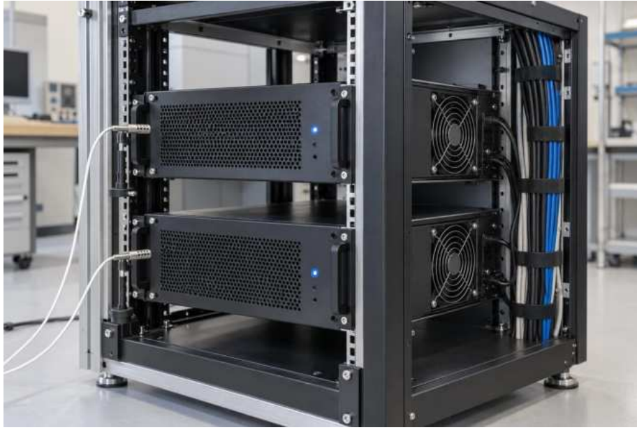
Şekil 4: İki elektronik yük taşıyan genel laboratuvar rack kabini; ön hava girişlerinin yakınında sıcaklık problemleri, yan fan ızgaraları ve çerçeve boyunca düzenlenmiş kablolar bulunuyor
