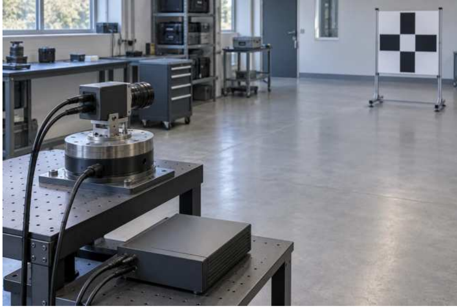
Şekil 1: Döner tabla üzerindeki bir kamera, optik devreye alma alanında sabit bir hedefe bakıyor; kameranın ve tablanın ayrı kabloları bir kayıt birimine gidiyor
